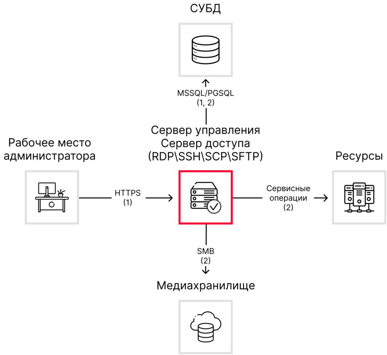
1. Подключение к кабинету администратора. Доменная аутентификация и регистрация/ предоставление второго фактора. Проверка пользователя в БД IdP.
