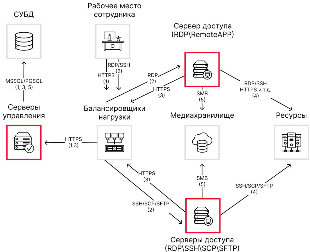
1. Подключение к личному кабинету пользователя через браузер или запуск Indeed PAM Desktop Console. Доменная аутентификация и регистрация/предоставление второго фактора. Проверка пользователя в БД IdP. Получение списка ресурсов из БД Core. Получение RDP-файла для подключения к ресурсу.
