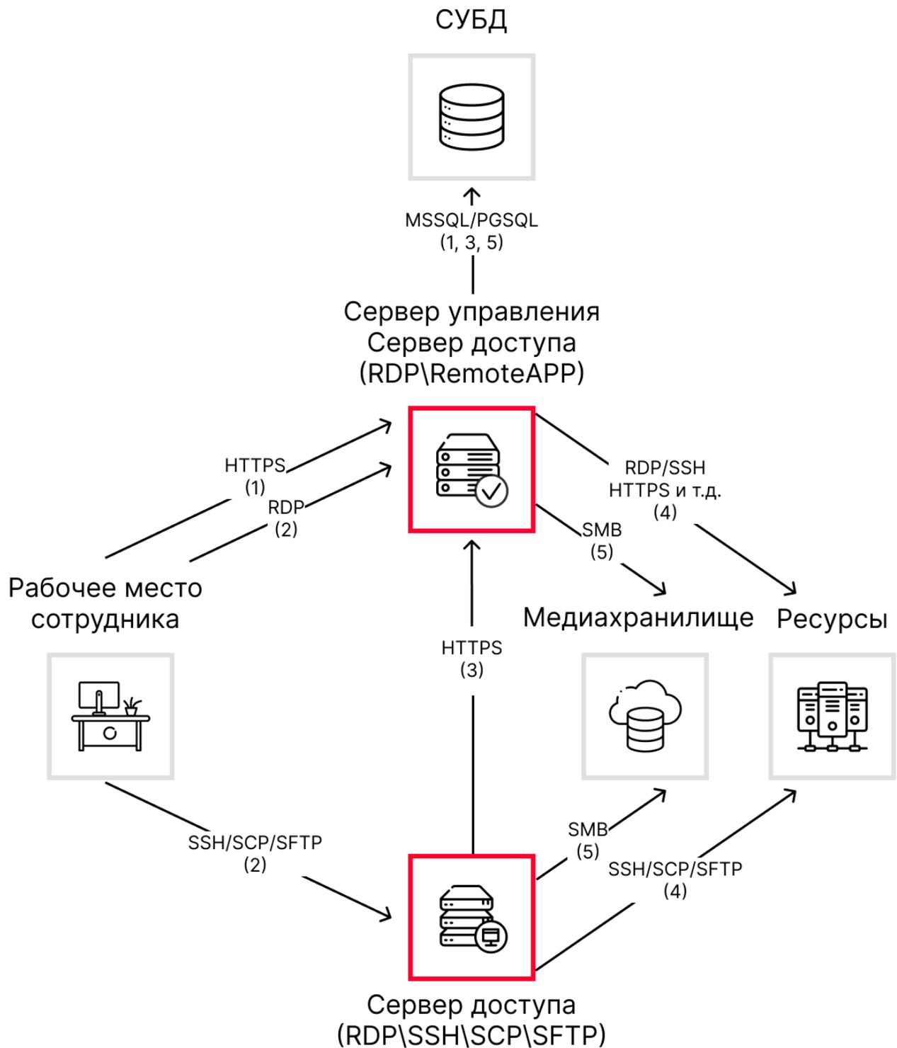
1. Подключение к личному кабинету пользователя через браузер или запуск Indeed PAM Desktop Console. Доменная аутентификация и регистрация/предоставление второго фактора. Проверка пользователя в БД IdP. Получение списка ресурсов из БД Core. Получение RDP-файла для подключения к ресурсу.
