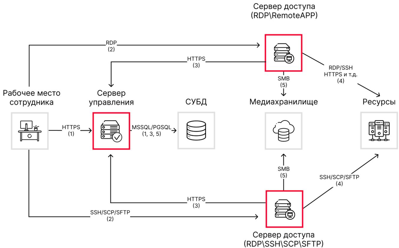
1. Подключение к личному кабинету пользователя через браузер или запуск Indeed PAM Desktop Console. Доменная аутентификация и регистрация/предоставление второго фактора. Проверка пользователя в БД IdP. Получение списка ресурсов из БД Core. Получение RDP-файла для подключения к ресурсу.
